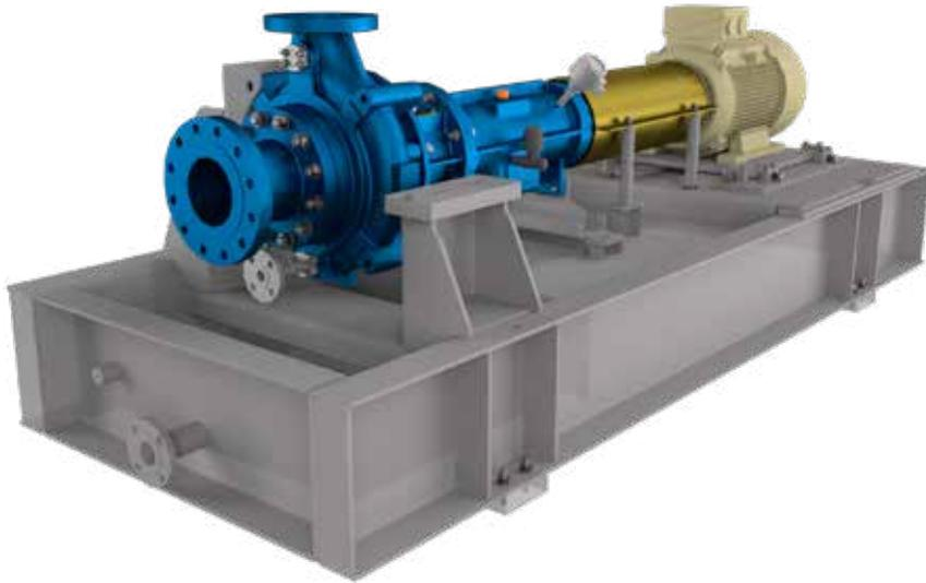
Les **pompes processus du série CPP** se caractérisent par leur construction horizontale. En plus leurs pieds sont positionnés sur le centre de l'arbre pour avoir une exécution selon API 610-OH2 ou ISO 5199-famille 3. Les pompes sont pour pressions de système de 40 bar comme standard, pressions plus hautes sont possibles. La pompe est livrable comme exécution immergé avec tube intermédiaire et plaque support (CPPVS).
