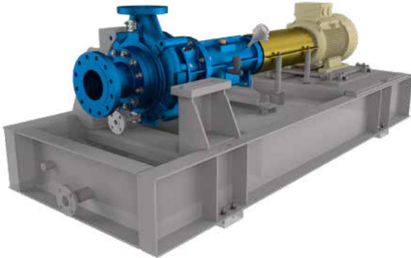
Die **Prozesspumpen der Baureihe CPP** zeichnen sich durch ihre horizontale Bauweise aus, außerdem befinden sich die Füße auf Achsmittle somit kann eine Ausführung nach API 610-OH2 oder ISO 5199-Familie 3 problemlos erfolgen. Die Pumpen sind standardmäßig für Systemdrücke von 40 bar ausgelegt, höhere Drücke sind möglich. Als Eintauchvariante mit Zwischenrohr und Aufsetzplatte ist unsere CPPVS lieferbar.
